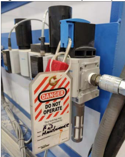
Figura 2-5: Cómo bloqueo/etiquetado el sistema neumático
