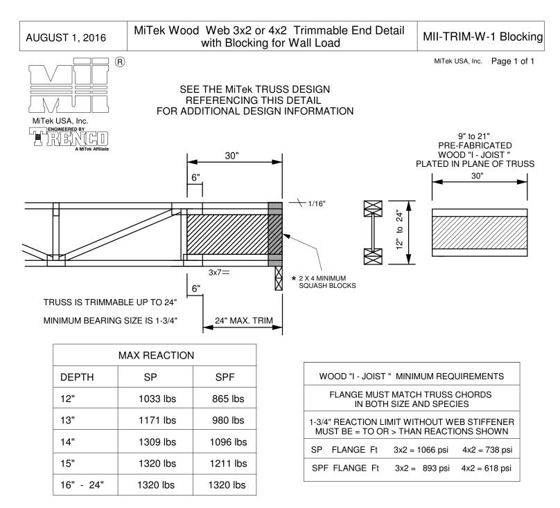
★ SQUASH BLOCKS REQUIRED WHEN WALL LOADS FROM ABOVE ARE PRESENT. SQUASH BLOCKS ARE TO BE 1/16" TALLER THAN TRUSS. ATTACH SQUASH BLOCKS TO EACH FACE OF TRUSS WITH THREE 10d (0.131" X 3") NAILS IN EACH END. MAXIMUM WALL LOAD IS 7612 LBS.
