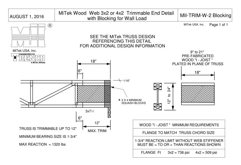
★ SQUASH BLOCKS REQUIRED WHEN WALL LOADS FROM ABOVE ARE PRESENT. SQUASH BLOCKS ARE TO BE 1/16" TALLER THAN TRUSS. ATTACH SQUASH BLOCKS TO EACH FACE OF TRUSS WITH THREE 10d (0.131" X 3") NAILS IN EACH END. MAXIMUM WALL LOAD IS 7612 LBS.
