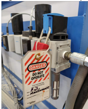
Figura 2-5: Cómo bloqueo/etiquetado el sistema neumático
