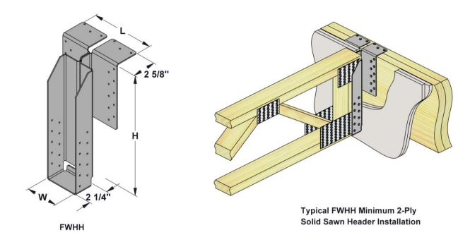
FIGURE 4—FWHH HEAVY-DUTY FIRE WALL HANGER AND TYPICAL INSTALLATION ON SOLID SAWN HEADER
