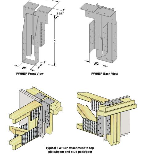
FIGURE 2—FWHBP FIRE WALL HANGER AND TYPICAL INSTALLATION
